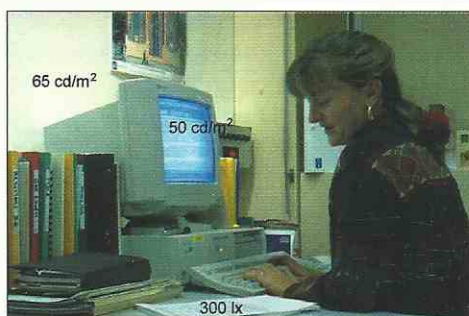
2. ábra: Fényeloszlás számítógépes munkához
