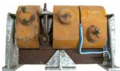
3. ábra FNV Szórótranszformátor 220 V primer, 2x3 kV szekunder, kb. 300 VA
