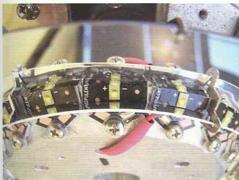
3. kép A LED-ek elhelyezkedése a tartóelemen
